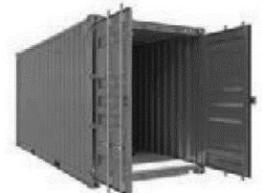
Beim **Transport in Containern** müssen die Produkte **innerhalb von 15 Tagen nach dem Versanddatum aus dem Container herausgenommen werden**, um eine Beeinträchtigung der vorlackierten Metaldeckschichten aufgrund der hohen Feuchtigkeitskonzentration zu vermeiden, die sich über einen langen Zeitraum im geschlossenen Container ansammeln kann.
